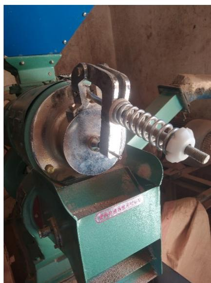
Figure 55: réglage du système de polissage
