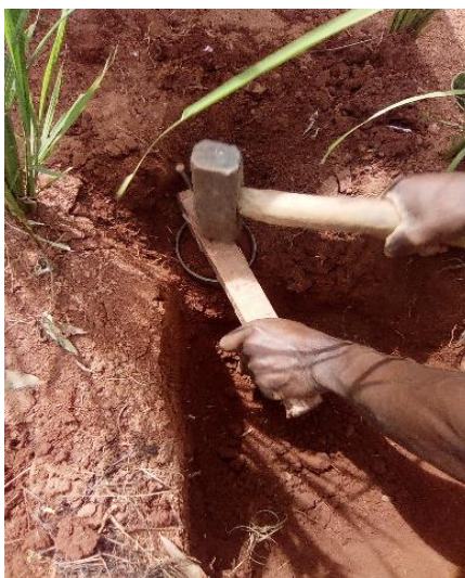
Cliché 3. Mesure de la densité apparente du sol par la méthode du cylindre
